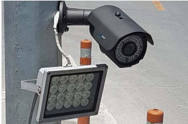
در نسخه های قدیمی نرم افزار از دوربینهای USB برای عکسبرداری و نیز تشخیص پلاک استفاده میشد اما اکنون دوربینهای حرفه ای IP چند مگا پیکسلی تحت شبکه این عملیات را انجام میدهند و کم کم استفاده از دوربینهای USB منسخ گردید.
