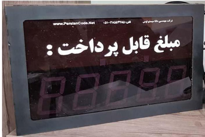
بسته به تعداد رقمهایی که سیگمنتها نشان میدهد سایزشان متفاوت است در حالت استاندارد سایز  $30 \times 20 \times 5$  cm میباشد که برای نمایش ۵ رقم استفاده میگردد.
